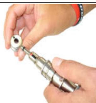
**IT** • Ruotare l'inseritore da lato "B" e posizionarlo sull'iniettore
